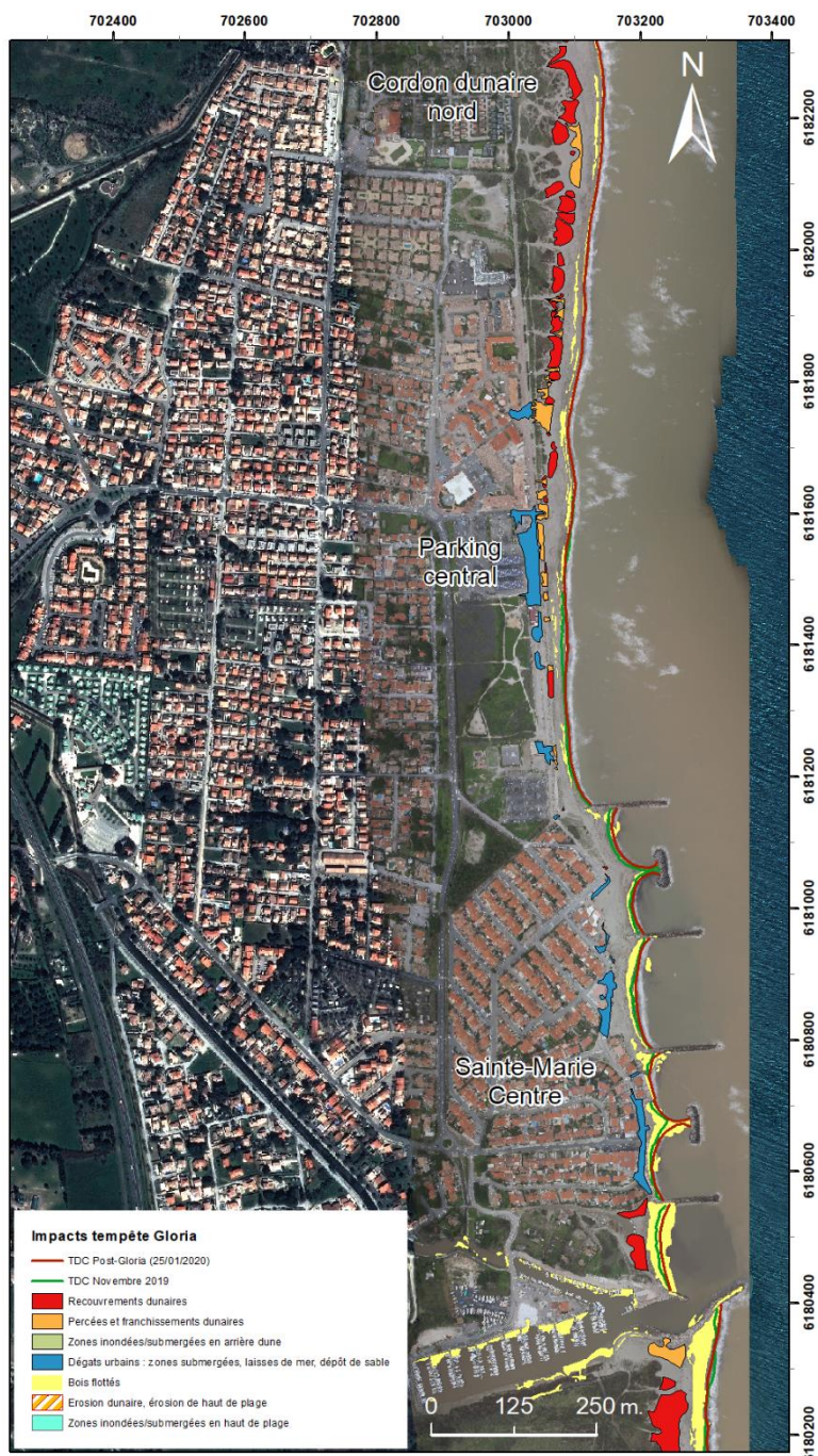
Illustration 171 - Impacts à la côte de la tempête Gloria : photointerprétation et comparaison des orthophotographies et topographies des levés photogrammétriques ObsCat post-tempête du 25/01/2020 et de la campagne de novembre 2019.
