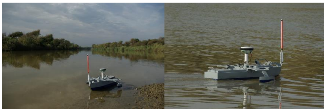
Illustration 33 – Drone bathymétrique Rimouski II en action dans l'embouchure de la Têt.
