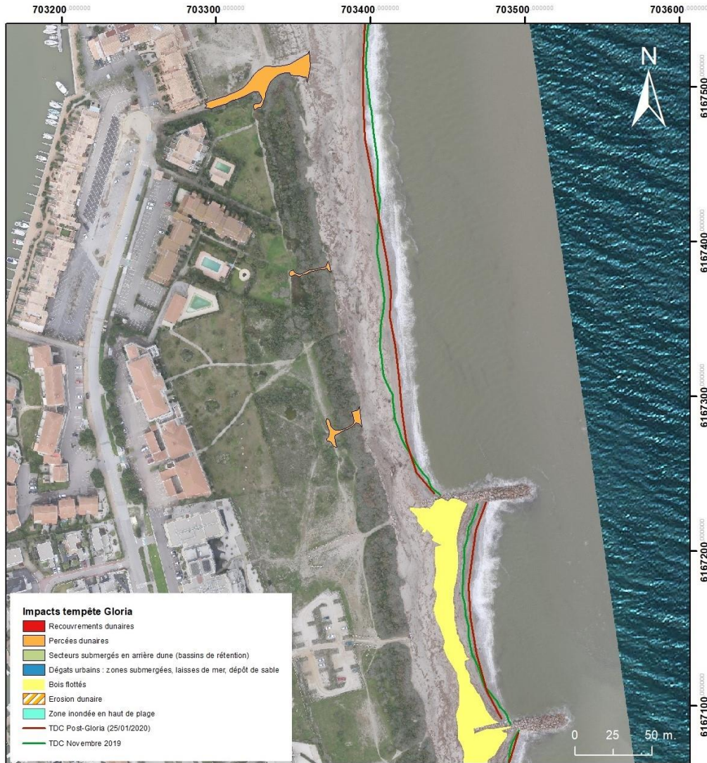
Illustration 113 - Impacts à la côte de la tempête Gloria : photointerprétation et comparaison des orthophotographies et topographies des levés photogrammétriques ObsCat post-tempête du 25/01/2020 et de la campagne de novembre 2019.
