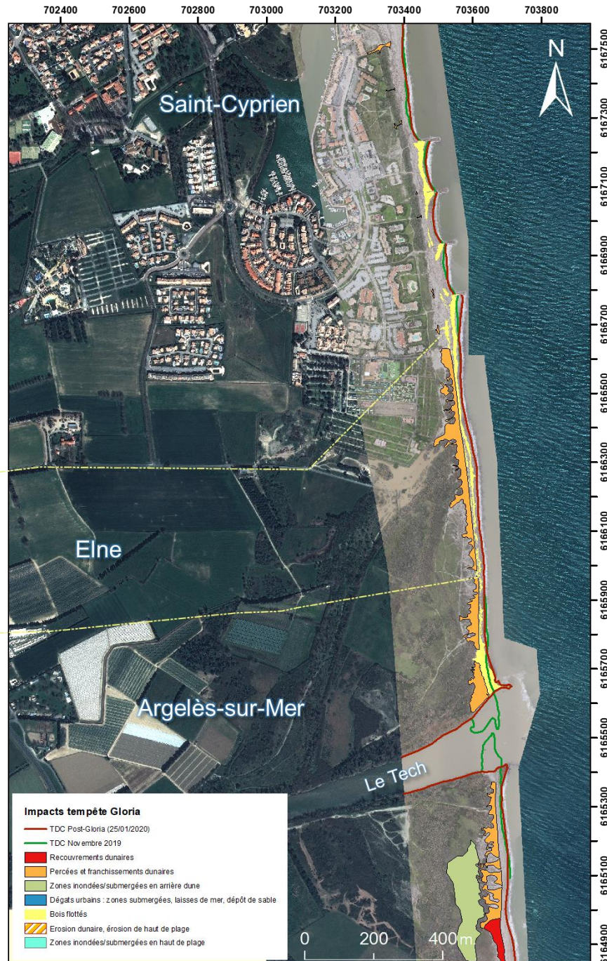
Illustration 103 - Impacts à la côte de la tempête Gloria : photointerprétation et comparaison des orthophotographies et topographies des levés photogrammétriques ObsCat post-tempête du 25/01/2020 et de la campagne de novembre 2019.
