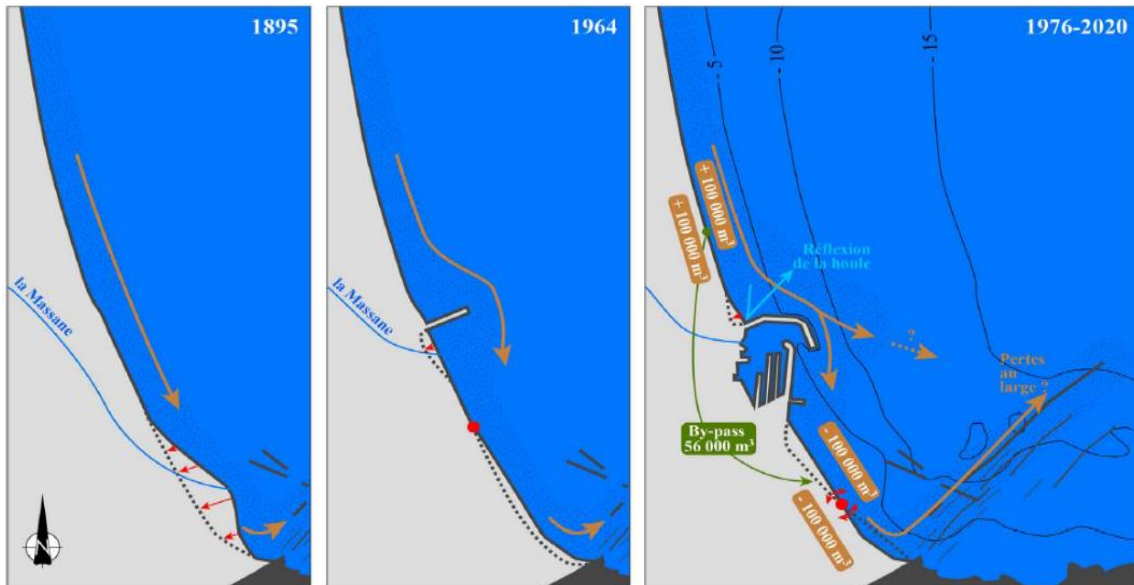
Illustration 68 - Schéma conceptuel du fonctionnement morphosédimentaire de la plage d'Argelès-sur-mer et du Racou, Certain et al. (2020).
