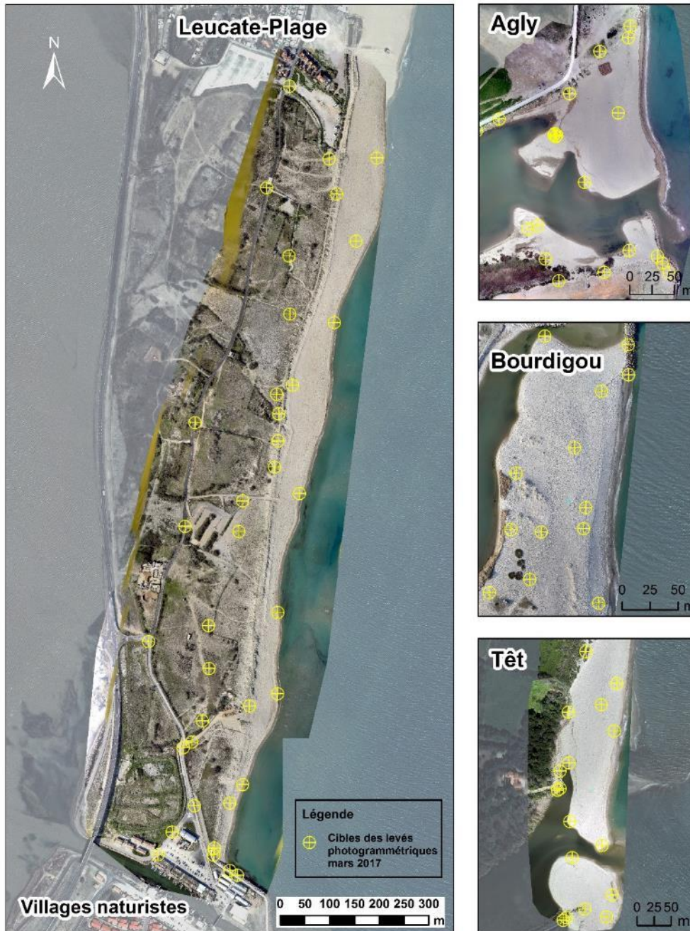
Illustration 9 - Exemple du positionnement des cibles pour les levés photogrammétriques.
