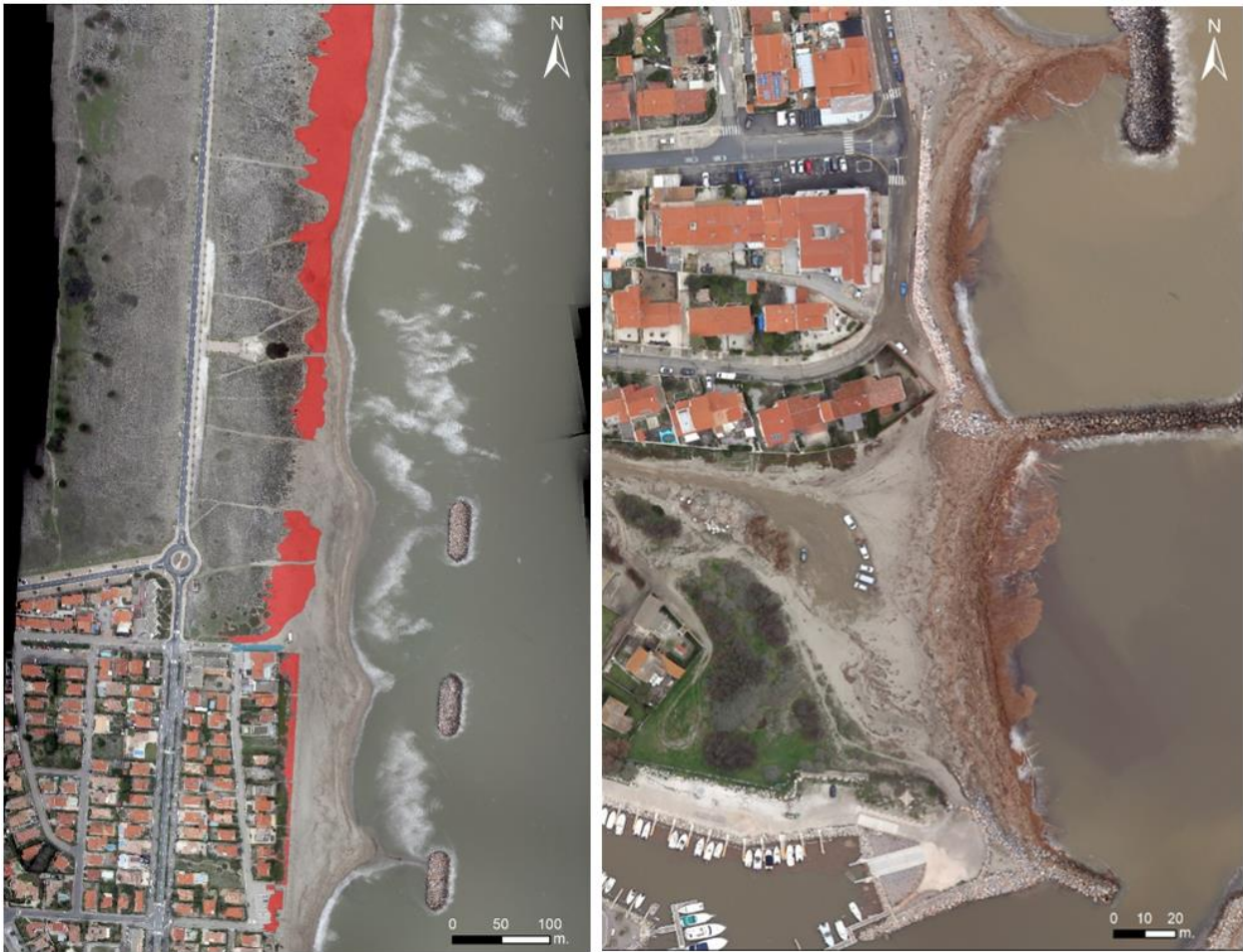
Illustration 47 - Orthophotographies post tempête Gloria - Exemples d'impacts. A gauche, recouvrements dunaires (en rouge) au niveau des secteurs de Port Barcarès Nord et du Mas de l'Isle. A droite, accumulation de bois flottés dans l'eau et sur la plage au nord de la sortie du port de Sainte-Marie.
