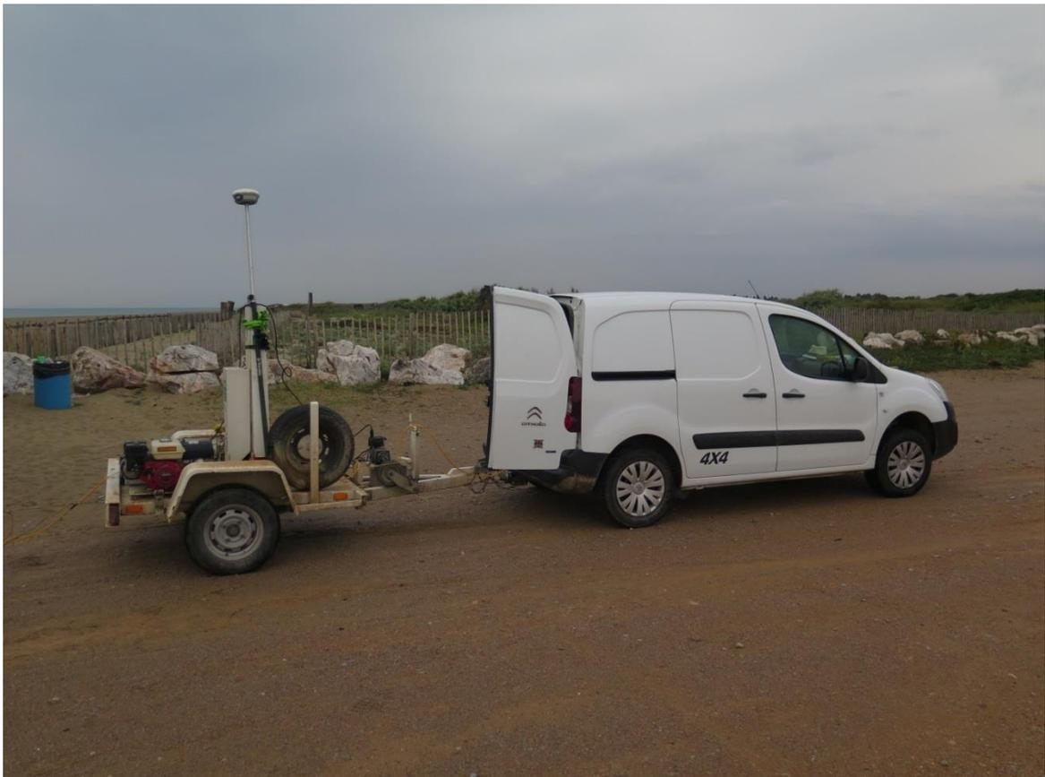
*Illustration 22 - Acquisition MASW sur les routes et pistes de la zone de la Ribera à Torrelles (BRGM, le 26/04/2017). La source sismique (plaque) est disposée sur la remorque en arrière.*
