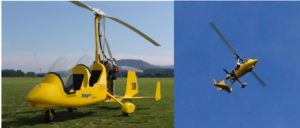
*Illustration 13 – Plateforme de vol autogyre. À gauche : modèle d'autogyre (source wikipédia) similaire à celui utilisé pour le levé du cordon dunaire de Leucate-Plage ; à droite photographie de l'appareil en action (source equipe terrain Obscat 2017).*
