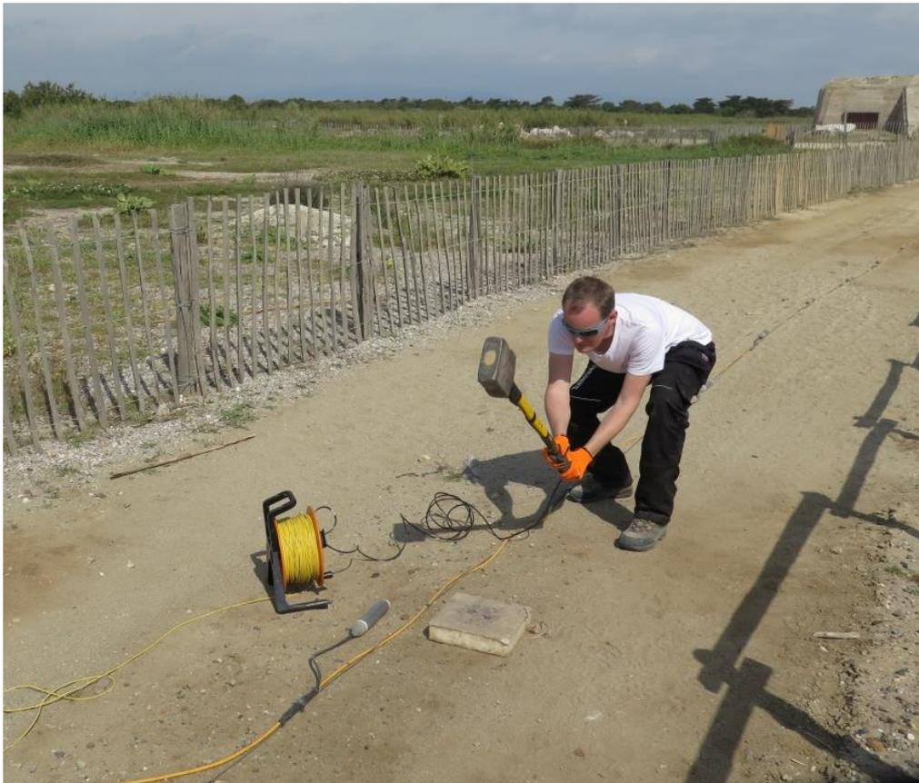
*Illustration 23 - Acquisition MASW sur les chemins dunaires de la zone de la Ribera à Torrelles (BRGM, le 24/04/2017). L'opérateur procède au tir en frappant une plaque posée sur la sol à l'aide d'une masse instrumentée.*
