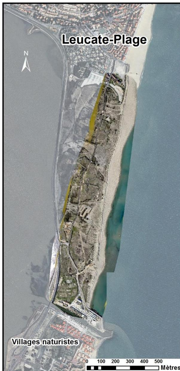
*Illustration 47 – Localisation du levé photogrammétrique par autogyre réalisé en mars 2017 sur le cordon dunaire de Leucate-Plage. Orthomosaïquage du levé en pleine couleur, sur fond Pléïades IGN 2015 estompé.*
