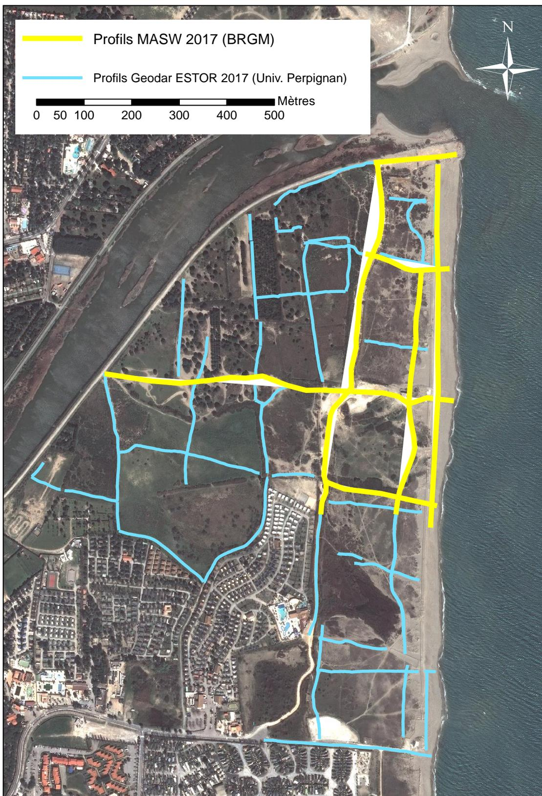
Illustration 15 - Site d'étude et schéma d'implantation des levés géophysiques acquis en 2017 dans le cadre de l'OBSCAT, par l'université de Perpignan (profils Georadar en bleu) et le BRGM (profils MASW en jaune).
