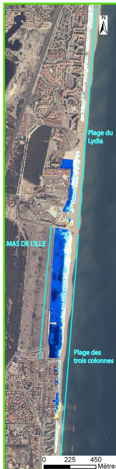
Illustration 93 : Différence altimétrique entre les MNS issus des acquisitions Lidar de 2010 et 2011 (fonds IGN).
