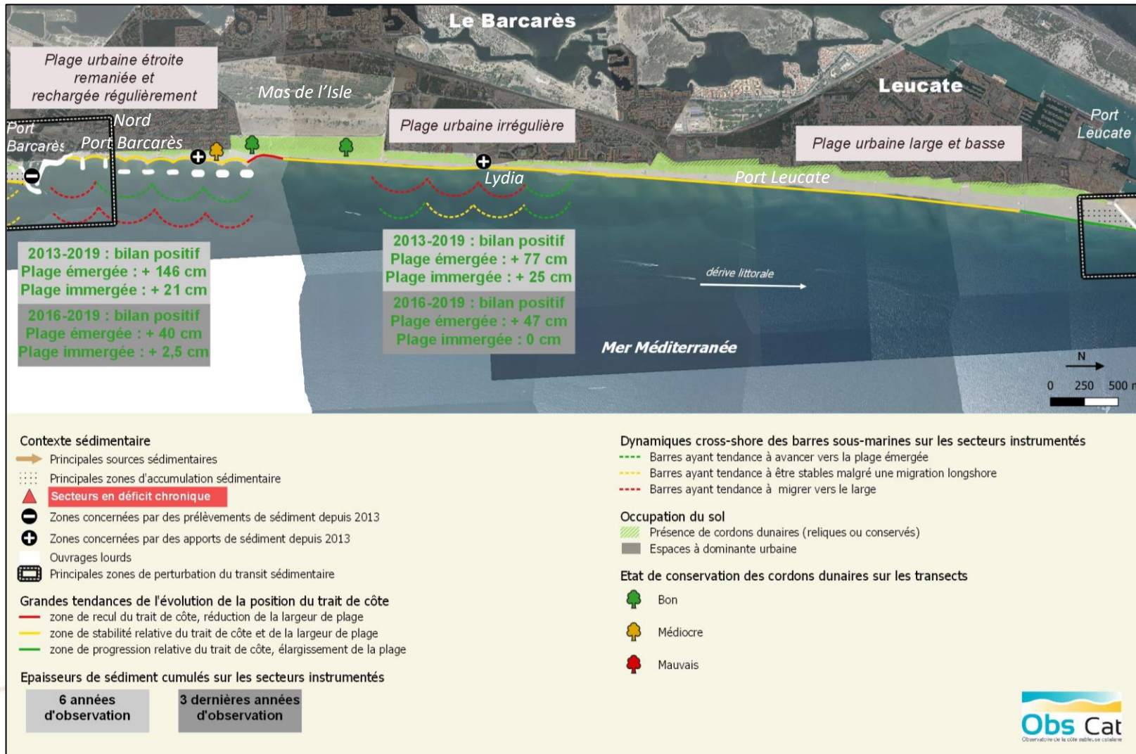
Fig. 20 : synthèse du fonctionnement de la sous-cellule 10 : de port Barcarès à Port Leucate
