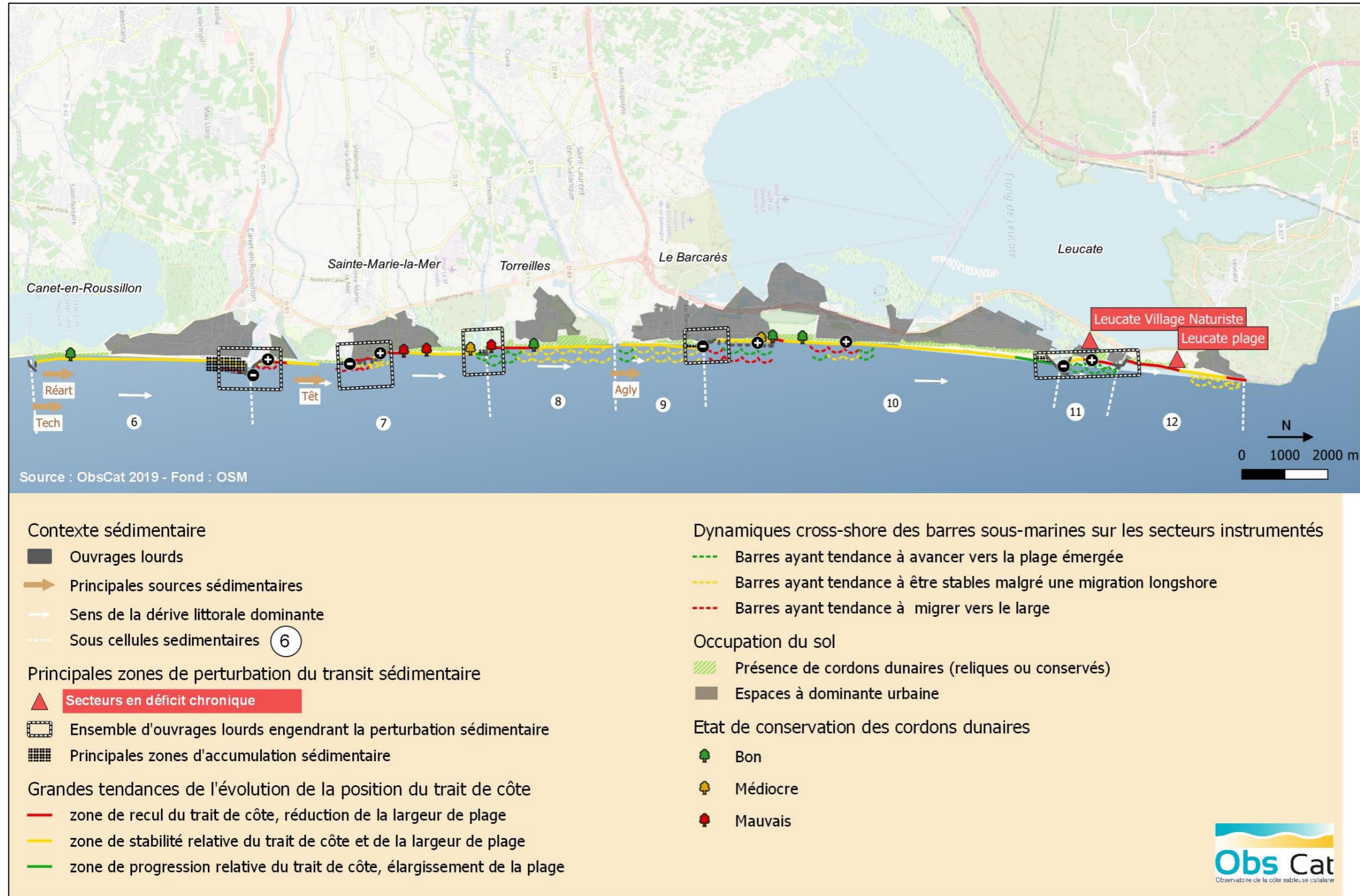
Fig. 23 : grands principes de fonctionnement morpho-sédimentaire sur l'unité sédimentaire du Roussillon
