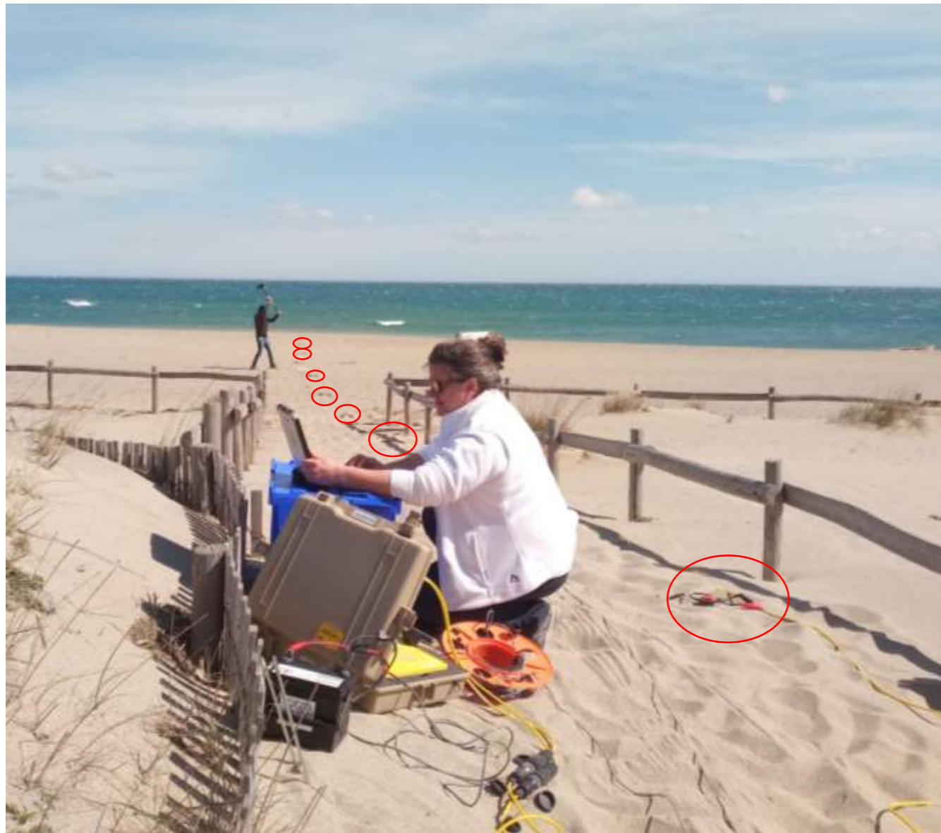
Figure 2 : Photographie de la campagne d'acquisition de sismique terrestre. Un opérateur paramètre et surveille l'enregistrement de l'arrivée des ondes P (au premier plan). La source des ondes est issue de la frappe à la masse en différents points le long du profil (en arrière-plan). Géophones cerclés de rouge.
