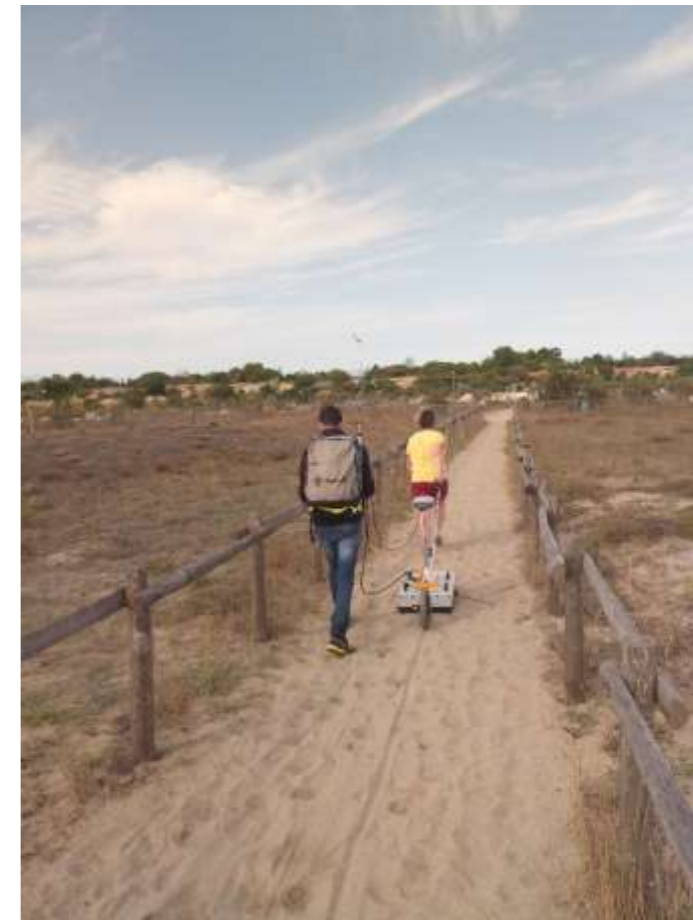
Figure 1 : Photographie de la campagne d'acquisition GPR, imageant l'antenne 250 MHz couplé à une antenne DGPS.
