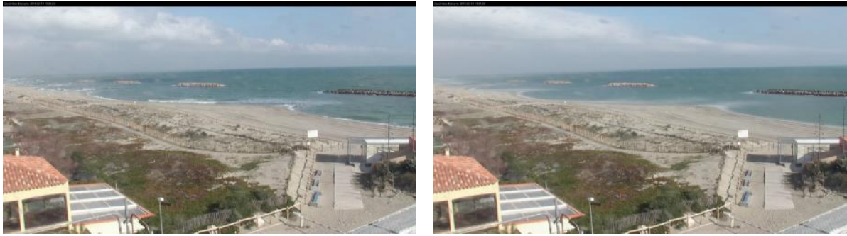
Illustration 11 - Exemples de prises de vue de la caméra C4. A gauche, image instantanée, à droite image moyennée Timex.
