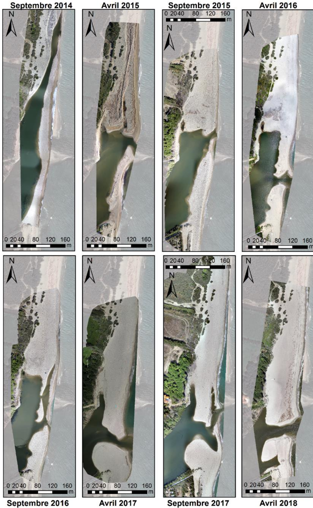
Illustration 189 - Orthophotographies aériennes de l'embouchure de la Têt prises entre septembre 2014 et avril 2018. Entre 2014 et avril 2017 : levés par drone. Depuis septembre 2017 : levés par autogire.
