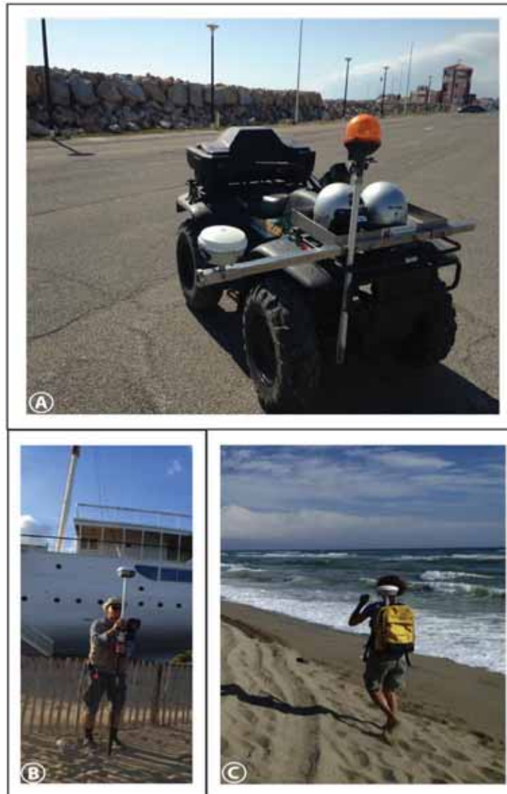
Illustration 4. Modes d'acquisition des données topographiques.
