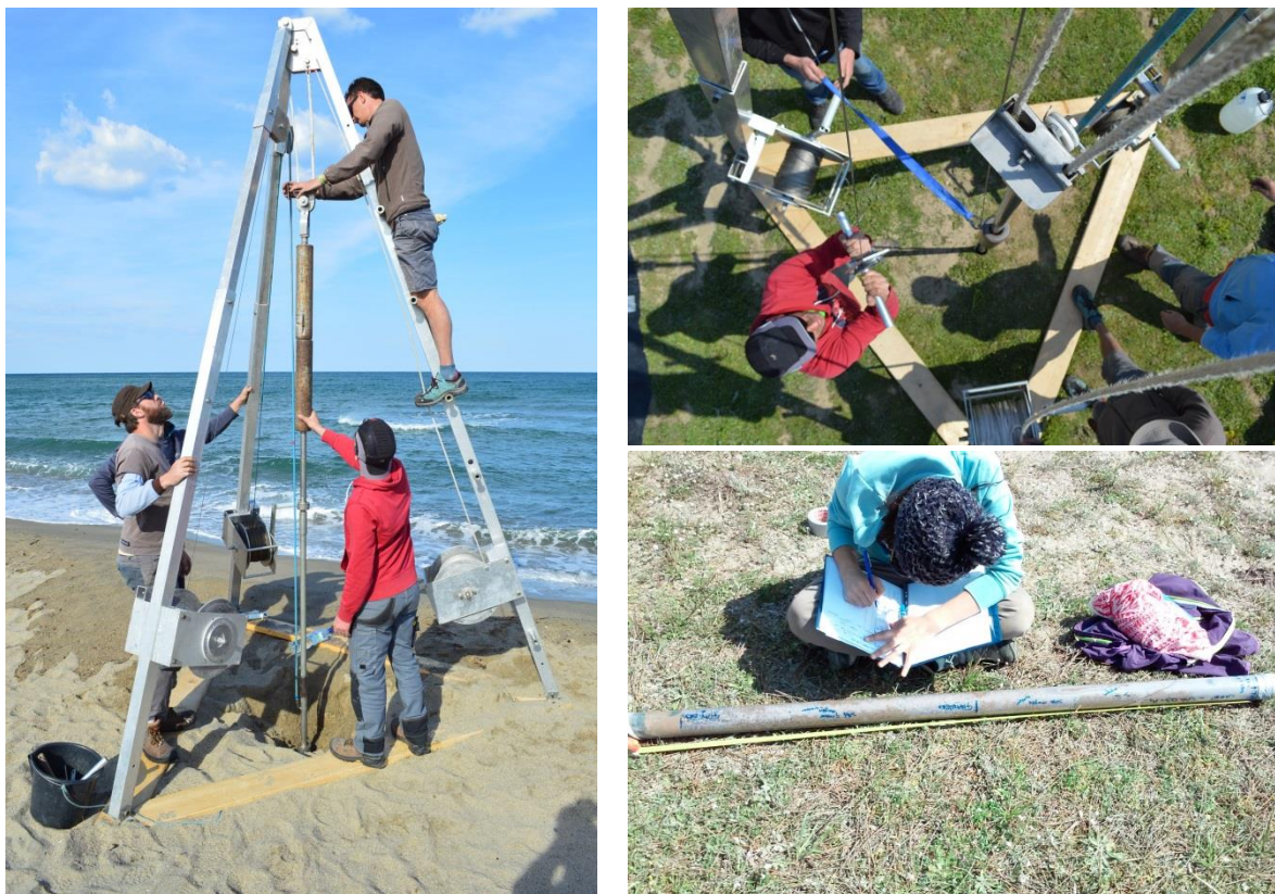
Figure 3 : Photographies de la campagne de carottage les 4-5 Avril 2017, imageant le carottier à percussion et le travail de description lithographique sur les carottes juste récoltées.
