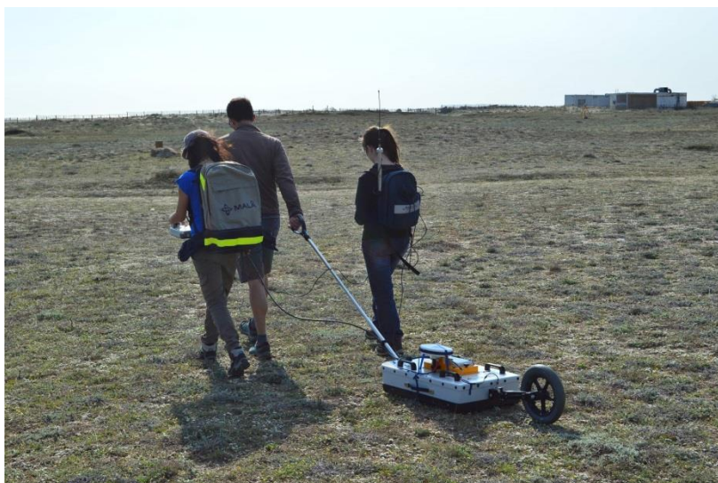
Figure 2 : Photographie de la campagne d'acquisition GPR (25/01, 09/02 et 04/04/2017), imageant l'antenne GPR 250 MHz couplé à une antenne GPS.
