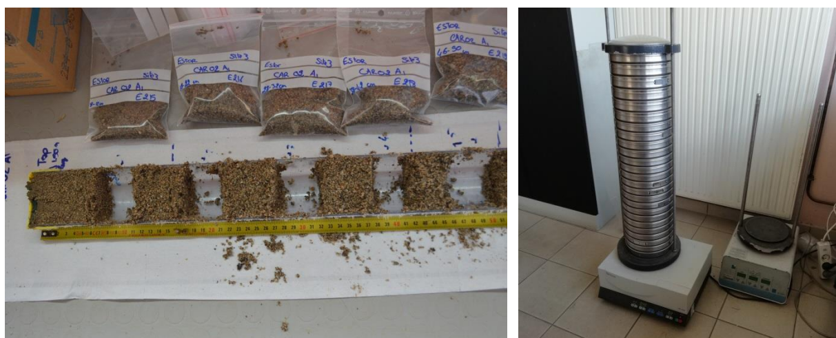
Figure 4 : Photographies de l'échantillonnage des carottes après ouverte (à gauche) au laboratoire CEFREM et analyse granulométrique des échantillons par colonne à tamis (à droite).
